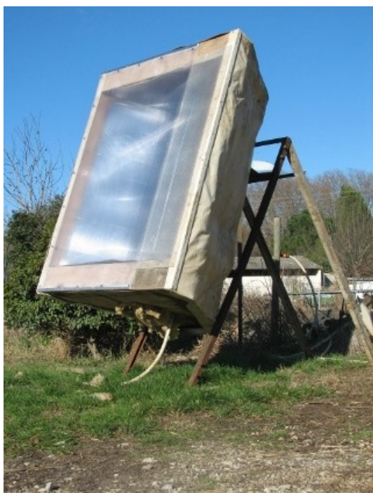
Du plastique alvéolé ferme la face avant (polycarbonate). Il est important qu'il y ai un espace d'air entre deux surfaces transparentes pour limiter les déperditions thermiques. On pourrait utiliser un double vitrage ou un cadre bois entouré de plastique de serre transparent. L'inclinaison à 55° permet une efficacité optimale l'hivers.
