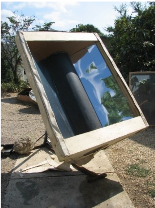
Première mise en place. Du réflecteur alu à été posé de part et d'autre du ballon. L'utilité de cette idée est à tester, dans tous les cas, du papier alu cuisine suffirait. Attention, le pied du support acier n'est pas assez avancé, il faudrait qu'il continu sur 40 cm car le centre de gravité du système est très en avant.
